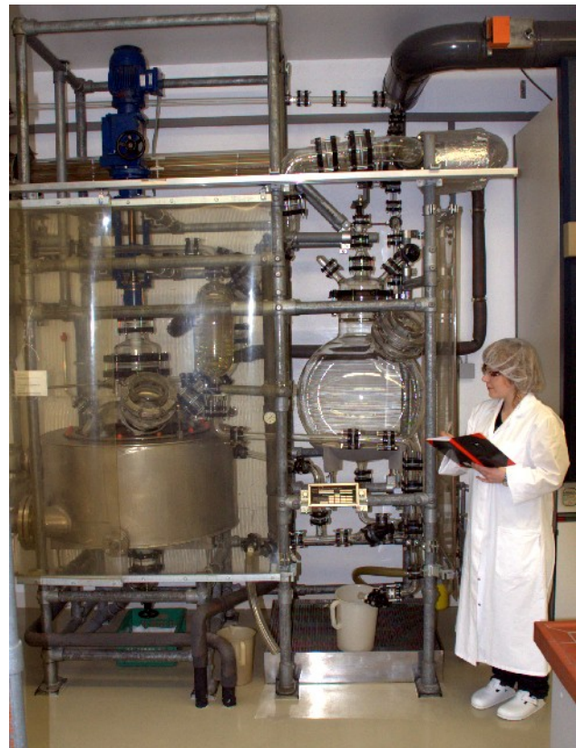
Abbildung 2: Vakuumdestillation der Tartarus-depuratus-Lösung
